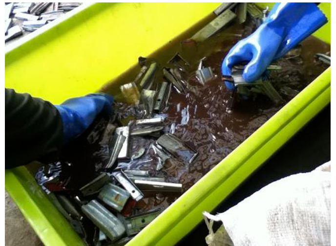
ビニールハウスを組立てる金具の洗浄：錆を軽油で洗う
